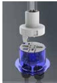
Die **PHILIPS SMART CAP** Technologie ist eine Entwicklung zur optimalen Sicherung! Der Lampenfuß und der Fitting, welcher in das Lampengehäuse gedreht wird, sind beide mit einem Sicherheitsschalter versehen. Sobald die Lampe aus dem Gehäuse geholt wird, wird die Stromzufuhr unterbrochen. Somit kann man nicht mehr in eine brennende UV-C-Lampe schauen. Dieses garantiert eine optimale Sicherheit während der Wartung.
