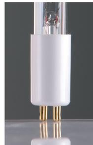
**T5 LAMPEN** sind ein-endige, keimtötende UVC-Lampen, die in kommerzielle Wasser und Luft desinfizierende Einheiten. Der kleine Radius von 16 mm Durchmesser erlaubt für ein kleines System Design und Design Flexibilität. T5 Lampen bieten ein fast konstante UV –Leistung, die ganze Lebensdauer über, für maximale Sicherheit der Desinfektion und hohe Wirksamkeit des Systems.
